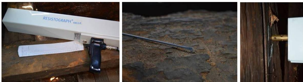
Obr. 9 Resistograph, vrták z wolframové oceli s průměrem dřívku 1,5 mm a špičky 3,0 mm.
